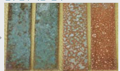
미처리 KBM-403 벤조 X-12-1214A 에폭시 실란 트리azol 처리 처리
